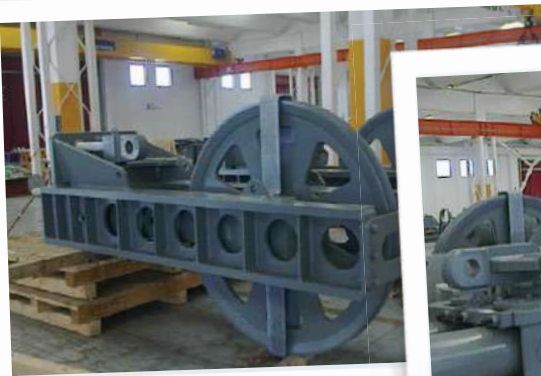
Poleas usadas para mover embarcaciones y compuertas
